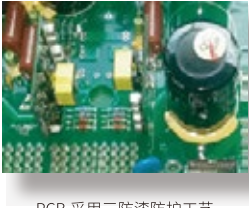
PCB 采用三防漆防护工艺
